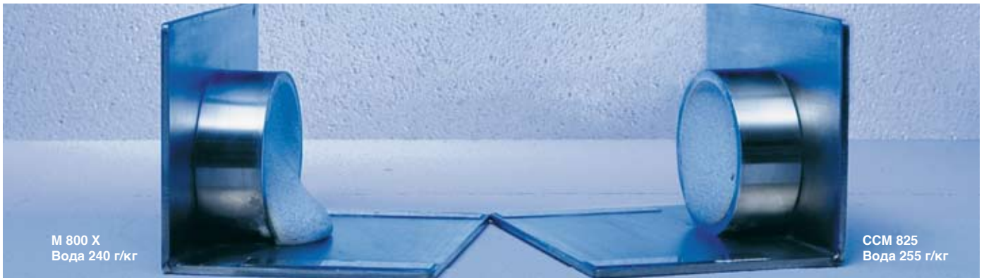
Разница в консистенции в стандартной рецептуре СТА при добавлении марок СТМ и стандартных марок
